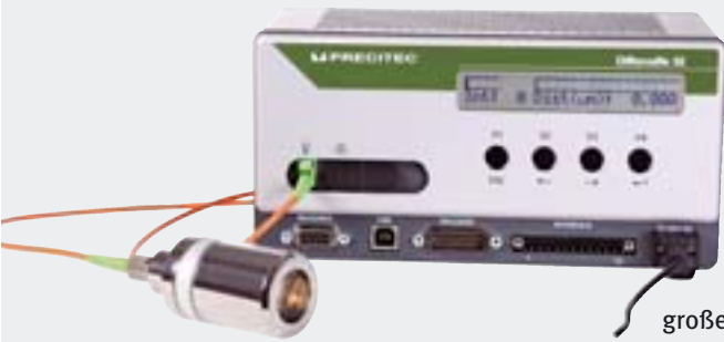
Optischer Sensor Chrocodile SE für die berührungslose Messung von Topografie und Schichtdicke. Der interferometrische Messbereich reicht von 3 µm bis 180 µm Bild: Precitec Optronik
