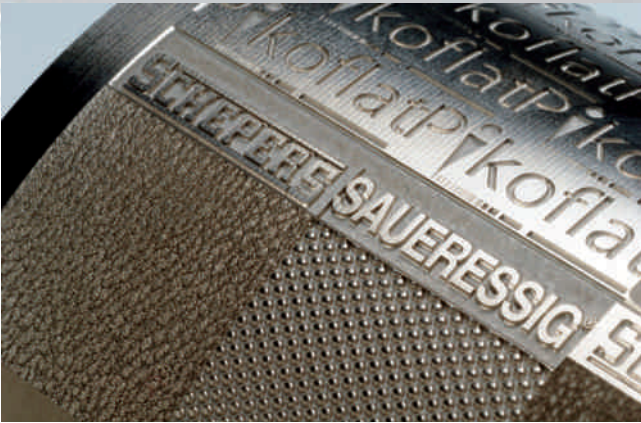
Kalotte und bearbeitetes Leder einer mit einem ps-Laser dreidimensional strukturierten Prägewalze. Bild: Schepers und ILT, Aachen. Rechts: Mit ps-Laser 3D-strukturierte Oberfläche einer Prägewalze (Durchmesser = 100 mm). Bild: Schepers und ILT, Aachen.
